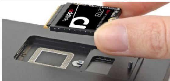
5. 工具を使ってエンクロージャーを開け、古いSSDを取り外し、塗布してあるサーマルペーストをきれいに取り除きます。
