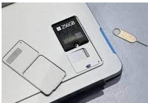
3. トルクスドライバーT3を使用して、SSDを固定しているネジ1本を取り外します。
