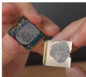
6. addlink S91 2230 SSDをエンクロージャーに挿入して閉じ、側面を軽く押して圧着します。
